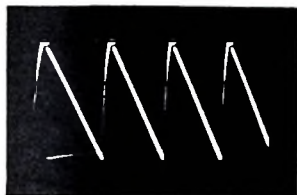
Bild 4. Sägezahnspannung an der Anode von Röhre 5 im selbstschwingenden Betrieb
