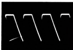
Bild 6. Sägezahnspannung an der Anode von Röhre 5 im Triggerbetrieb: die waagerechten Abschnitte stellen die Wartezeit dar, an die sich der Vorlauf anschließt
